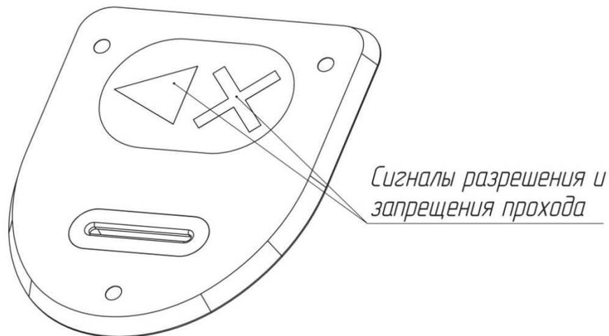
*Рис. 2. Внешний вид панели индикации картоприемника*
