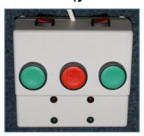
Пульт выполнен в виде небольшого настольного прибора в корпусе из пластика, который снабжен гибким кабелем. На лицевой панели корпуса расположены три кнопки управления: кнопка «СТОП» (красная) для установки турникета в режим «Закрыт», «←» и «→» для установки прохода в выбранном направлении. Рядом с кнопками расположены соответствующие световые индикаторы.
