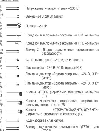
LT001) Программируемое подключение фотоэлементов
