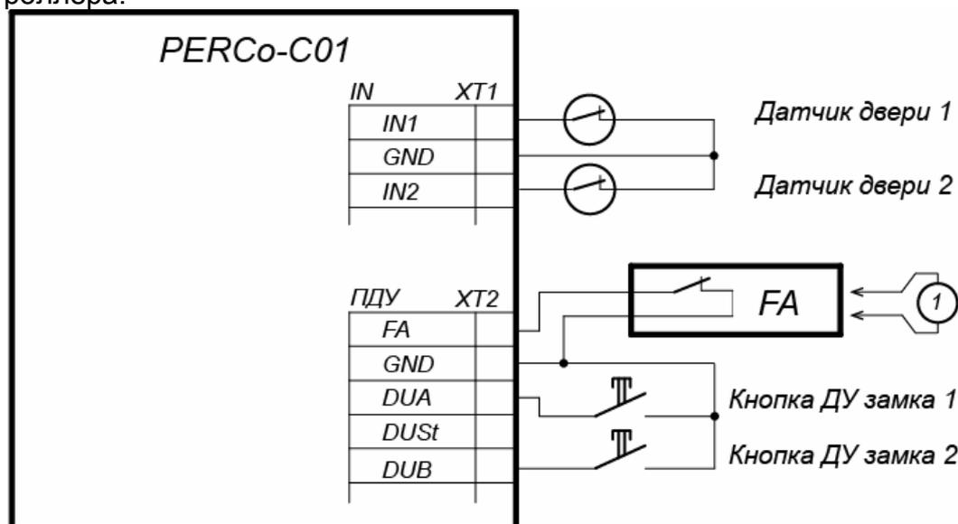
① – провод-перемычка, устанавливается при отсутствии устройства FA
