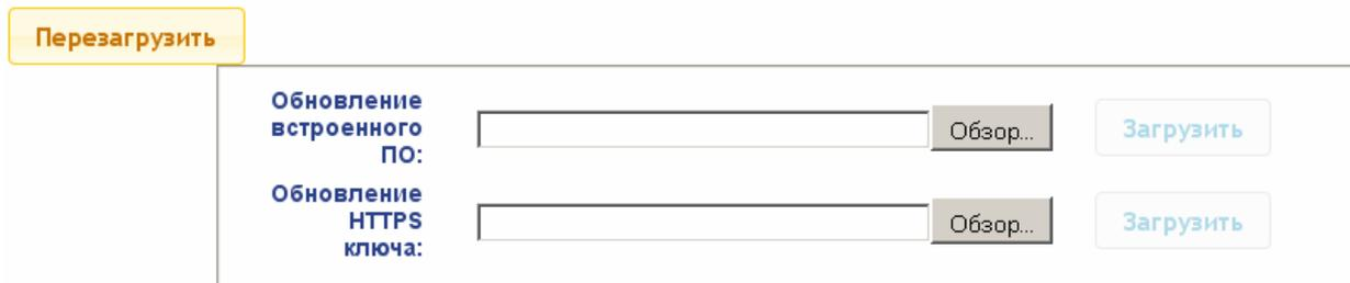
2. Для обновления ключей шифрования укажите в строке **Обновление HTTPS ключа:** с помощью кнопки **Обзор** место расположения файла с ключами и нажмите кнопку **Загрузить**. Начнётся передача файла в устройство. Справа от кнопки **Загрузить** появится индикация процесса загрузки в виде количества процентов загруженного файла.
