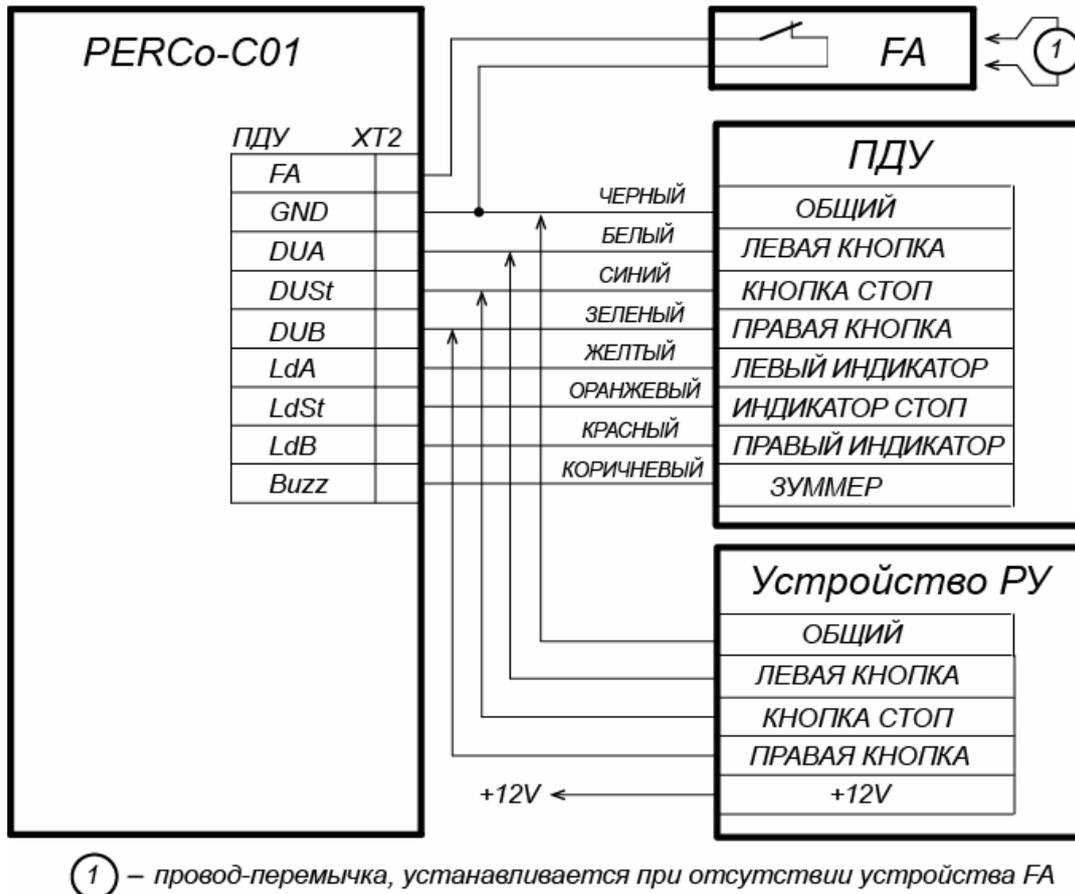
① – провод-перемычка, устанавливается при отсутствии устройства FA
