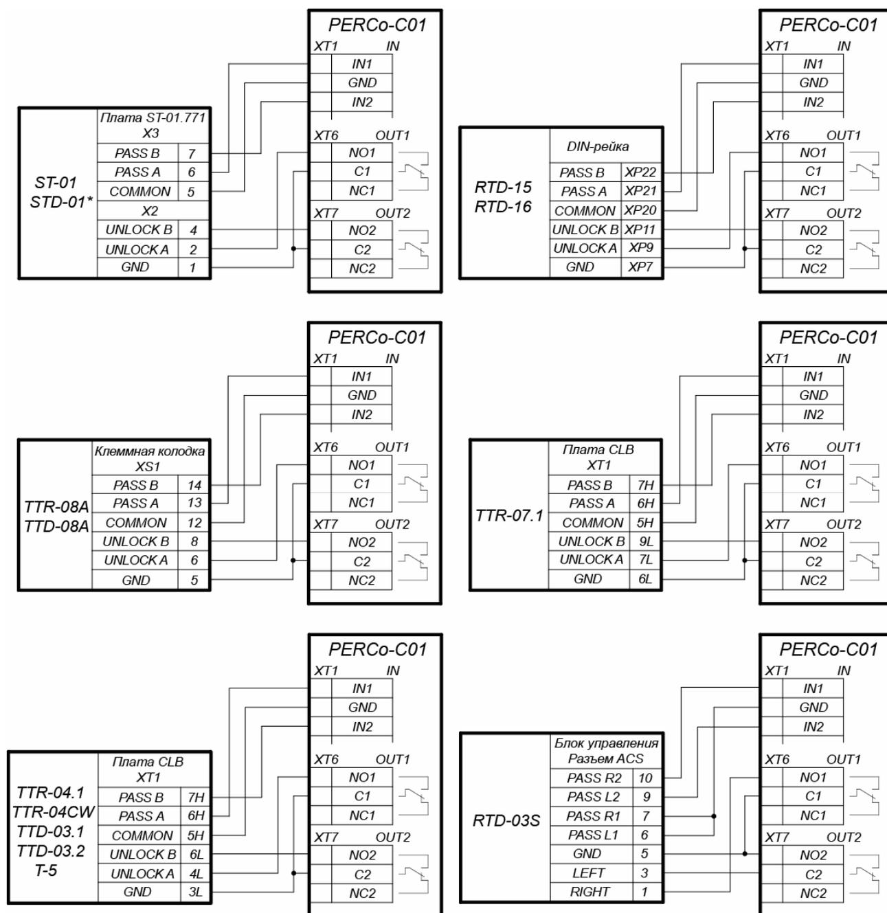
\* - для скоростного прохода PERCo-ST01(STD-01) выходы PASS A и PASS B должны быть сконфигурированы, как нормально разомкнутые
