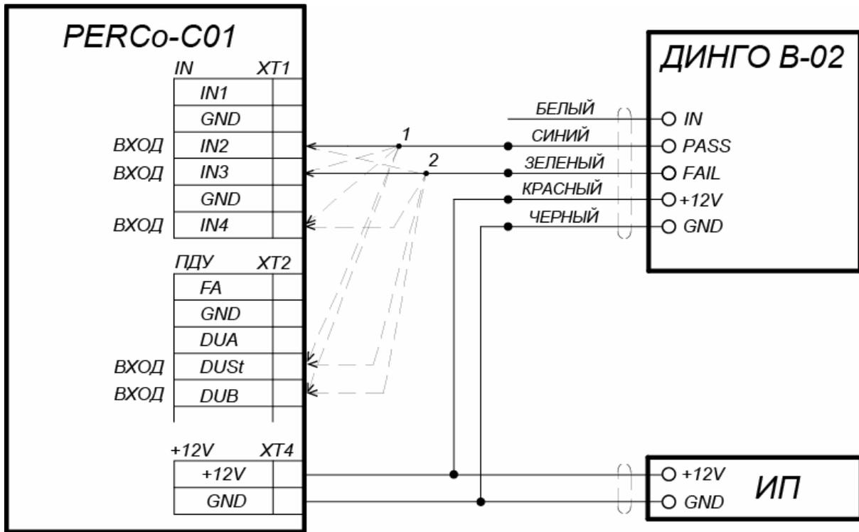
1, 2 - для подключения ДИНГО В-02 используются два разных входа контроллера из любых свободных.
