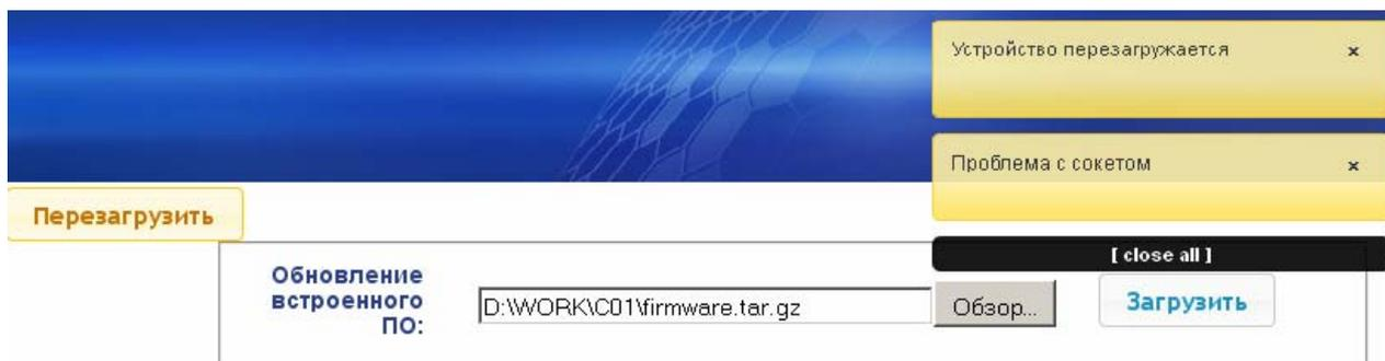
5. Процесс перезагрузки и обновления прошивки занимает от нескольких секунд до нескольких десятков секунд. В течение процесса могут появляться всплывающие окна с текстом о проблеме с сокетом. По окончании процесса обновления прошивки появится всплывающее окно с текстом «Сокет готов».
