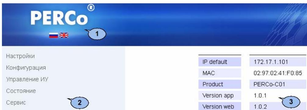
На главной странице отображается модель, конфигурация, сетевые настройки контроллера и версия встроенного ПО.
