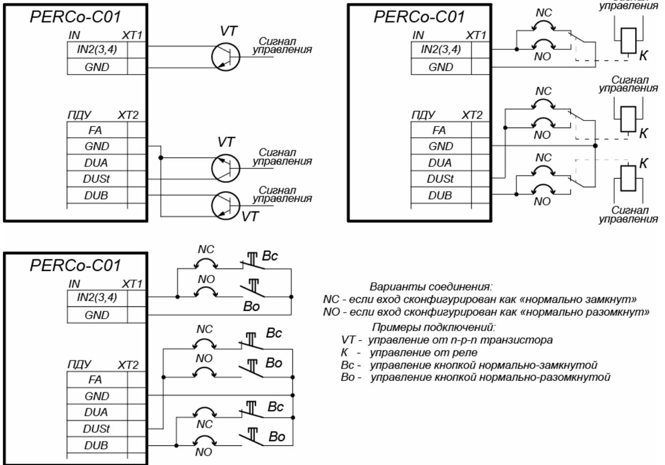
Рисунок 16. Схема подключений дополнительного оборудования к входам контроллера
