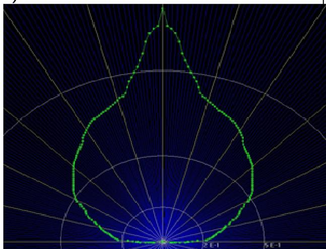
\*\*\*) Для видеокамеры, оснащенной варифокальным объективом. Комбинированный набор линз формирует универсальную диаграмму направленности ИК-излучения, обеспечивающую:
