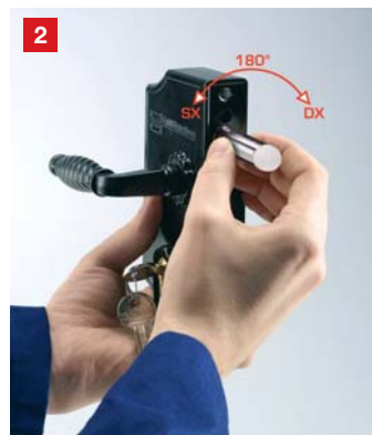
2 Regolare lo scrocco destro-sinistro Adjust the right or left latch Régler le pêne demi-tour droite-gauche Eistellen Sie di Rechts- oder Linksrichtung des Schubriegels.
