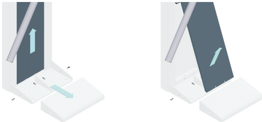
Рисунок 36 – Демонтаж центрального кожуха ЭП.
