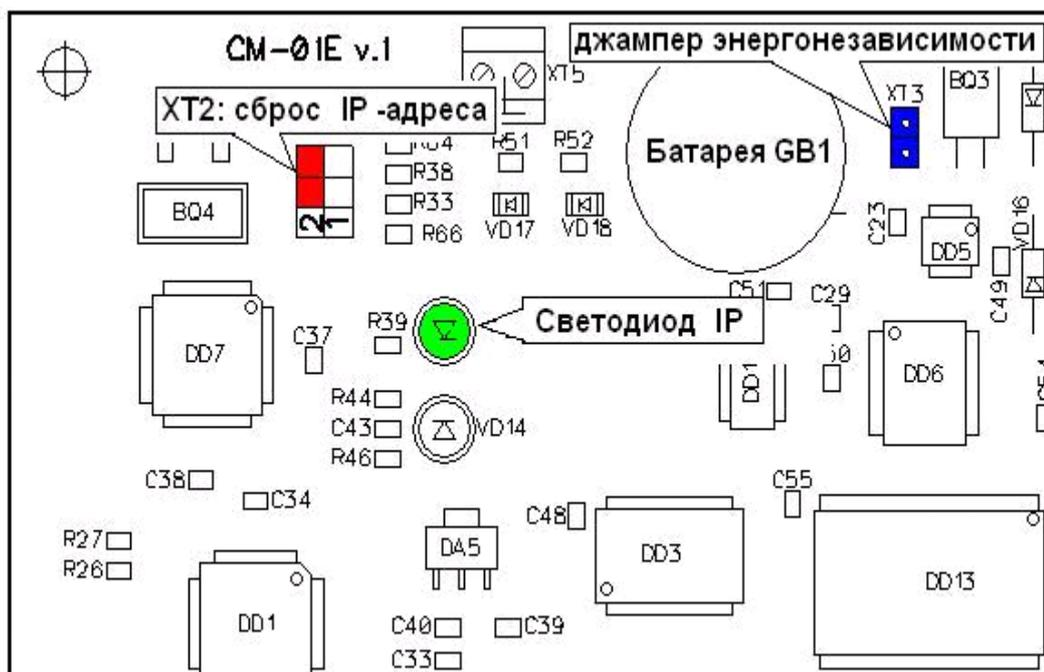
Рис.4 Подготовка контроллера к работе
