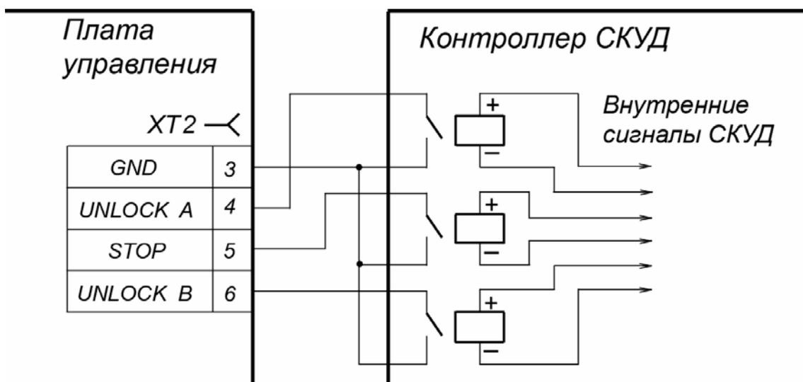
**Рисунок 6. Управляющий элемент СКУД нормально разомкнутый контакт реле**
