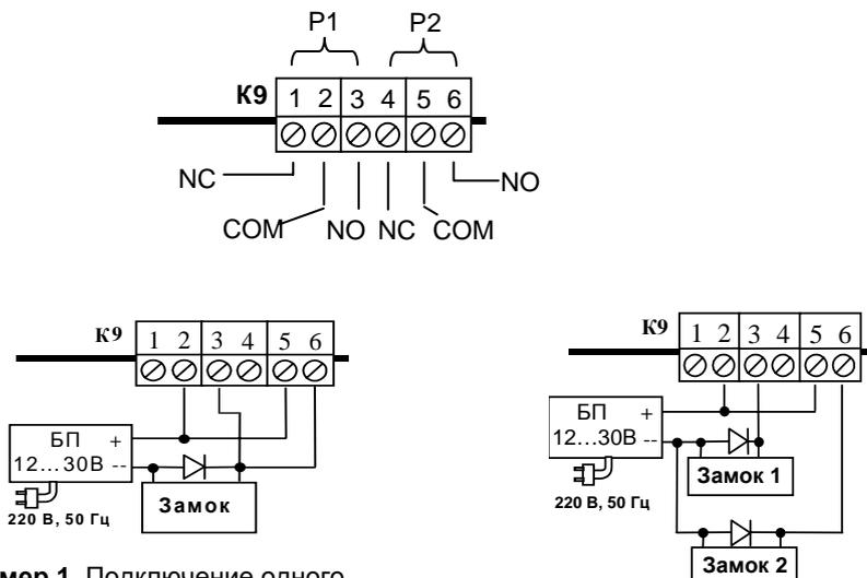
**Пример 1.** Подключение одного электромеханического замка через контакты обоих реле, т.е. оба считывателя (вх. и вых.) управляют одним замком (одна дверь)
