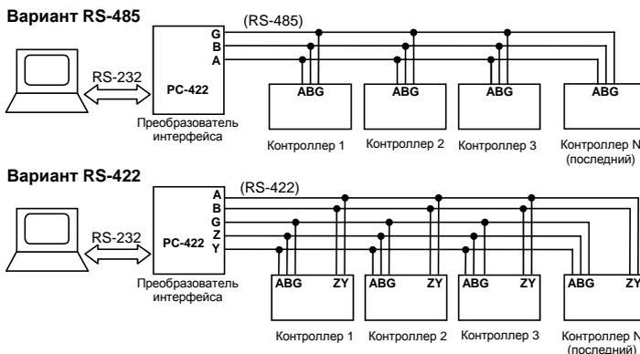
На рисунке приведены два варианта подключения контроллеров к компьютеру. Термин "последний" означает, что контроллер является физически последним в линии связи.
