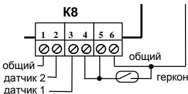
При работе контроллера с турникетом устанавливают два геркона, т.к. турникет включает в себя два исполнительных механизма.
