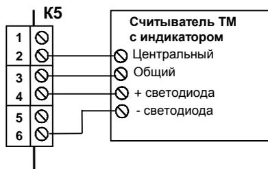
**Пример подключения** Proximity-считывателя PW-101 с выходом «Wiegand-26»
